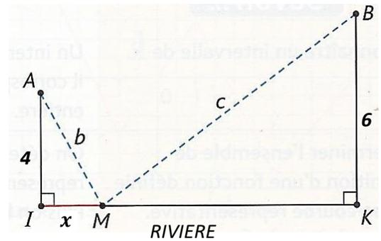
On cherche à placer le point M de façon à obtenir une longueur de canalisation minimale. C'est-à-dire que l'on recherche la distance  $x$  qui permette d'avoir une somme  $MA+MB$  la plus petite possible.
