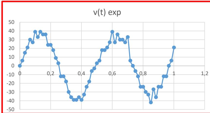
**Q1** : Quelle est la vitesse maximale atteinte lors de ce mouvement ? Dans quelle position de la masse (basse, milieu, haute) cette vitesse est-elle atteinte ? **La vitesse maximale est d'environ 40 cm/s**
