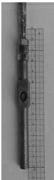
On étudie à présent le mouvement avec une masse  $m$  de 100 g. Ici, le ressort est étiré jusqu'à ce que l'abscisse  $x$  du point bas soit de -10 cm. Au temps  $t = 0$ , la masse est lâchée et se met à osciller. On a donc  $x(0) = -10$ . Ce mouvement a également été filmé avec la caméra GoPro (60 images par seconde)
