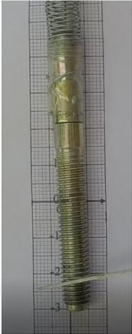
On débute ce travail avec une masse  $m$  de 30 g. Le ressort est étiré jusqu'à ce que l'abscisse  $x$  du point bas soit de -3 cm. Au temps  $t = 0$ , la masse est lâchée et se met à osciller. On a donc  $x(0) = -3$ . Ce mouvement a été filmé avec une caméra GoPro avec 60 images par seconde (sur les caméras usuelles, c'est 23 images par seconde).
