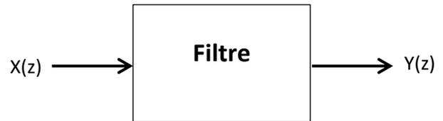
4- Une entrée Impulsion est appliquée. La suite  $x_n$  est :  $\{x_n\} = \{1; 0; 0; 0; \dots\}$ . Donner  $X(Z)$  et calculer :  $Y(Z)$
