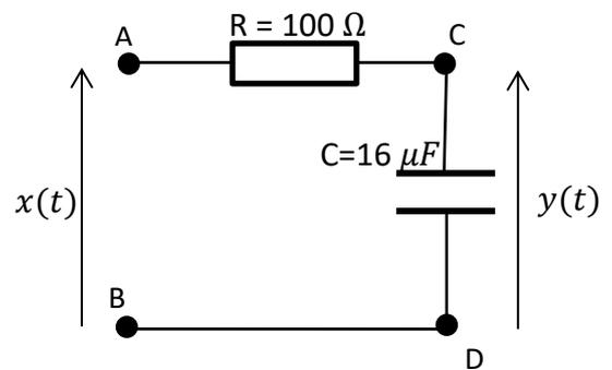
Si on pose :  $\tau = RC = 1. 10^2 \times 16. 10^{-6} = 0,0016$ , pour trouver la tension de sortie  $y(t)$  en fonction de celle d'entrée  $x(t)$  il faut résoudre l'équation différentielle :
